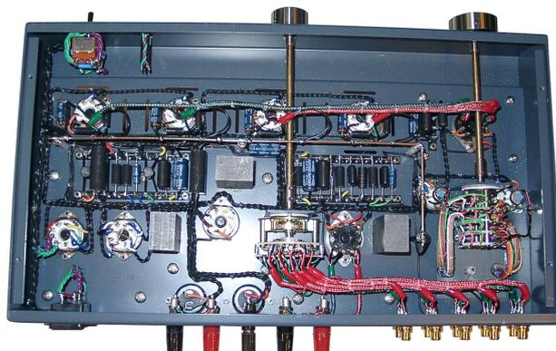
Integrato stereo push-pull valvola 6AS7G in classe A1, attenuatore in ingresso ATT.
