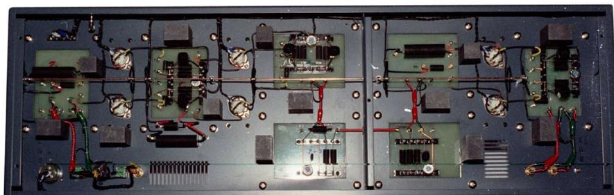
In questa coppia di amplificatori mono tutti gli stadi sono push-pull accoppiati a trasformatore; vengono realizzati nuclei ultra large in Super Permalloy, sono già previsti i trasformatori step-up MC e la RIAA è implementata con la tipologia LC.
